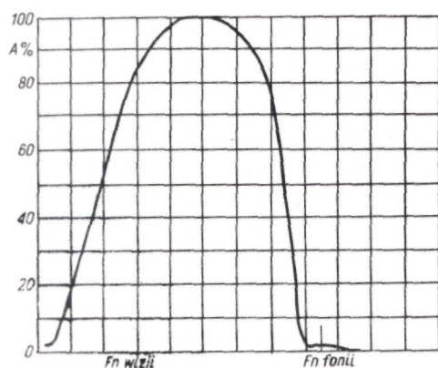
Rys. 10. Charakterystyka prawidłowego zestrojenia toru wizji /od anteny do detektora/
